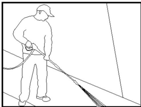
Рис. 6 - Оптимальный угол распыления воды относительно поверхности
